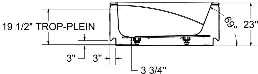
Ce dessin technique est universel pour toute les configurations de bain ModulR (coin Gauche/droite & Wallmounted)
