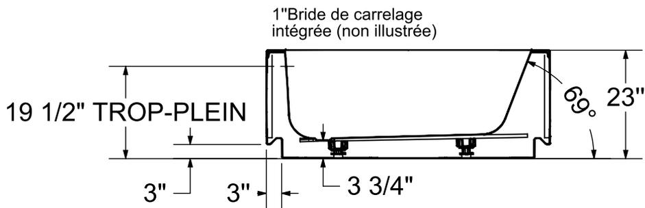
Ce dessin technique est universel pour toutes les configurations de bain ModulR (coin Gauche/droite & Wallmounted)
