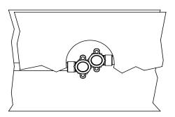
Optimize your rough configuration for a minimum C-C between hot & cold inlets (see examples) Optimisez la configuration du brut pour minimiser le C-C entre l'entrée de l'eau chaude et froide
